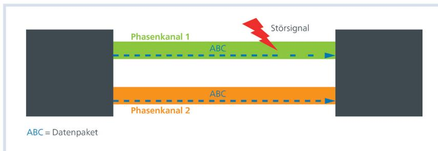
Bei der Mehrphasen-Einkopplung werden zwei Kanäle zur Datenkommunikation verwendet. Dadurch wird die Verbindung zwischen den BPL-Geräten deutlich robuster und performanter.
