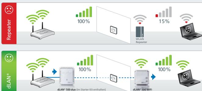
devolo nutzt für die Verbindung des dLAN® 500 WiFi das hausinterne Stromnetz. Dieses ist stabil und schnell. So steht an jeder Steckdose, in die ein dLAN® 500 WiFi Adapter eingesteckt wird, die volle Bandbreite des DSL-Anschlusses zur Verfügung. Ganz im Gegensatz zu einem WLAN-Repeater: Dieser leitet nur ein bereits schwaches Signal weiter. Die Folge: Eine weiterhin schlechte WLAN-Verbindung!
